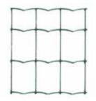
rete elettrosaldata zincata e plastificata attraverso il processo di plastificazione "GALVAPLAX PROCESS" colore verde alpi, l'alta resistenza dei fili verticali fornisce alla rete una tensione uniforme, favorendo un facile montaggio, evitando la deformazione delle maglie, garanzia 10 anni contro la corrosione; utilizzo: recinzione residendiali, industriali, rotolo da mt.25
